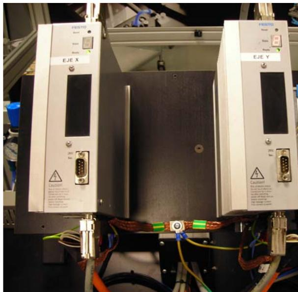
Ilustración 5 - Tarjetas de control de ejes
