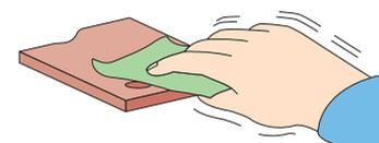
↑ Figura 1.51. Lijado de la superficie de una barra para su conexión eléctrica.
