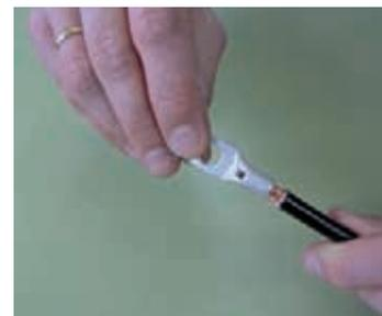
↑ **Figura 1.37.** Fijación de un terminal en un cable.
