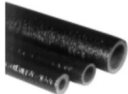
Se necesita aislar la tubería a todo lo largo del trayecto, incluyendo los adaptadores y los accesorios de cierre. Es necesario, asegurar el mínimo grosor de aislamiento proyectado en todo el diámetro de la tubería a lo largo del trayecto (es decir que el aislamiento, que se pone a la tubería separado, nuevamente debe, después del montaje, unirse a todo el perfil, por ejemplo por medio de pegamento, corchetes o por cinta adhesiva).
