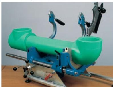
– Soldadura terminada después de enfriarse
